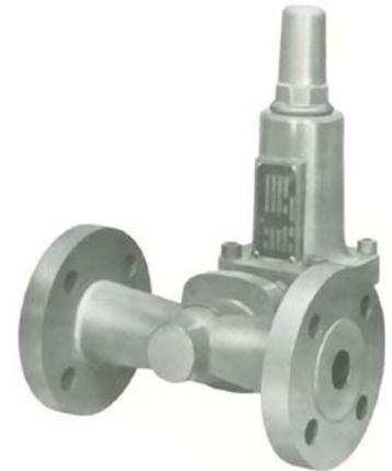
**Sicherheitsabsperrventil „SAV“**, DIN-DVGW zugelassen, mit WZ 2.2 nach EN 10204, Gehäuse GGG 40.3, Absperrbereiche verstellbar, mit Membranbruchsicherung. Sobald ein bestimmter oberer Ansprechdruck erreicht ist, wird der Gasdurchfluss durch das Sicherheitsabsperrventil (SAV) abgesperrt. Das Öffnen des SAV erfolgt manuell.
