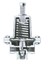
**Flüssigphase-Druckminderer**, PN 40, mit APZ 3.1 nach EN 10204, membrangesteuerter, federbelasteter Proportionalregler für Durchsätze von 150 – 900 l/h, Anschluss 1/2" NPT IG Gehäuse Edelstahl, Ausgangsdruck verstellbar
