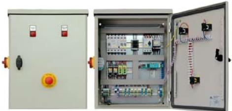
**MSR-Schaltschrank** für Flüssiggasanlagen der **GRUPPE B**, Standardausführung, Fabrikat P&A, zur Ansteuerung der Überfüllsicherung, Magnetventil in der Füllleitung, Hupe für den Vor- und Hauptalarm, Rundumleuchte, Schnellschlussarmaturen, Druckluftversorgung, Not-Aus-Taster, Sicherheitsschutzkombination, Meldeleuchten und Verdampferanlage, mit Ausgang für die KKS-Anlage, komplett verdrahtet, mit Schalt- und Klemmenplan.
