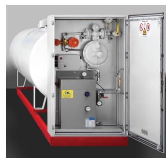
Verdampferanlage komplett im Schrank montiert, z.B. Typ PA/P-150, Leistung 150 kg/h, Ausgang EO 22 Ausführung B= mit Mittel- und Niederdruckregler, geeignet für Aufstellung in Ex-Zone 2, Ex-Bauteile mit ATEX-Zulassung, Elektrische Ausrüstung gemäß VDE, Schutzart IP 54, Elektroanschluss 400V , 50 Hz ca. 26.000 W
